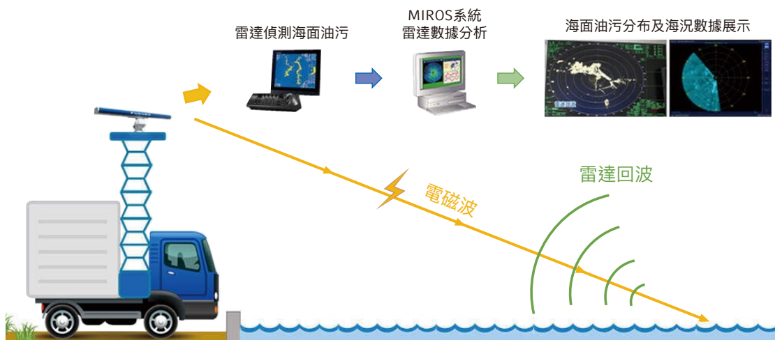
圖 3-13 海污監測雷達車作業示意圖
